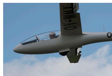
Specielle luftbremser på OY-MMX
